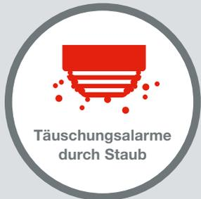
Mit der Zeit gelangt Schmutz in den Rauchmelder und Bauteile altern. Dadurch können Täuschungsalarme ausgelöst werden.
